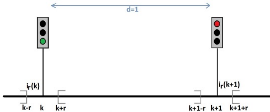
FIGURE 2 – Schéma de feux avec zones d'influence.
